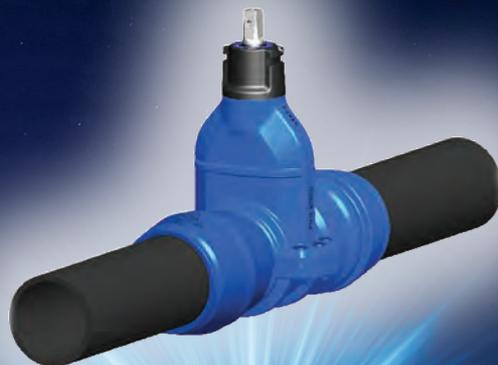
Med Ulefos Aquosus får du längsta möjliga livslängd och friheten att välja vilken anslutning som passar bäst. Ventilen har syrafast sluss som tätar mot en armerad tätningsinsats. Minst 250 µm epoxy säkerställer högsta kvalitet på korrosionsskyddet. Med ett unikt fabriksmonterat modulkoncept går det att anpassa ventilanslutningarna till varje specifik installation.
