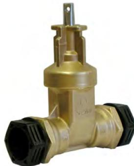
\* Dy 63: Tryckskruv av AMETAL® med kona av Acetalplast. Vid montering; kontrollera att tryckskruven är insmord med fett. Montera rör, skruva tryckskruven helt in mot ventilen. Annars samma montering som andra storlekar.
