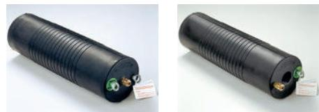
ULEFOS Rörpropp SB1 och SB2 är framtagen för att tåla tuffa tag och används med fördel vid proppning av markförlagda ledningar med en innerdiameter från 40-1800 mm. Propparna är tillverkade av högkvalitativt gummi med kevlarförstärkt kord och designade för maximal friktion mot rörväggen.
