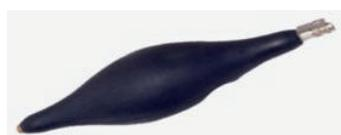
Ulefos Rörpropp SF1 är en propp för gas- och VA-ledningar, med en innerdiameter från 50-500 mm, där proppen bara kan föras in i ledningen via ett mycket begränsat utrymme, t ex ett avstick. Propparna är utrustade med snabbkopplingsventil.
