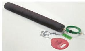
Ulefos Rörpropp SC1 är en lång propp för att täta anslutning och huvudledning på samma gång. Propparna klarar innerdiametrar från 50-150 mm. Propparna är försedda med en 100 cm lång tryckslang. En kedja, monterad på ventilstäket, med ett päronformat handtag i andra änden, gör att risken att proppen följer med in i röret minimeras. Propparna är tillverkade av högkvalitativt gummi med kevlarförstärkt kord.
